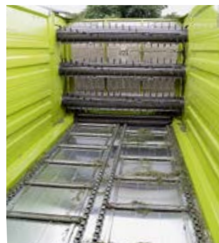
Der konische Aufbau ist von Claas auch für den Transport von Hackschnitzeln freigegeben.
