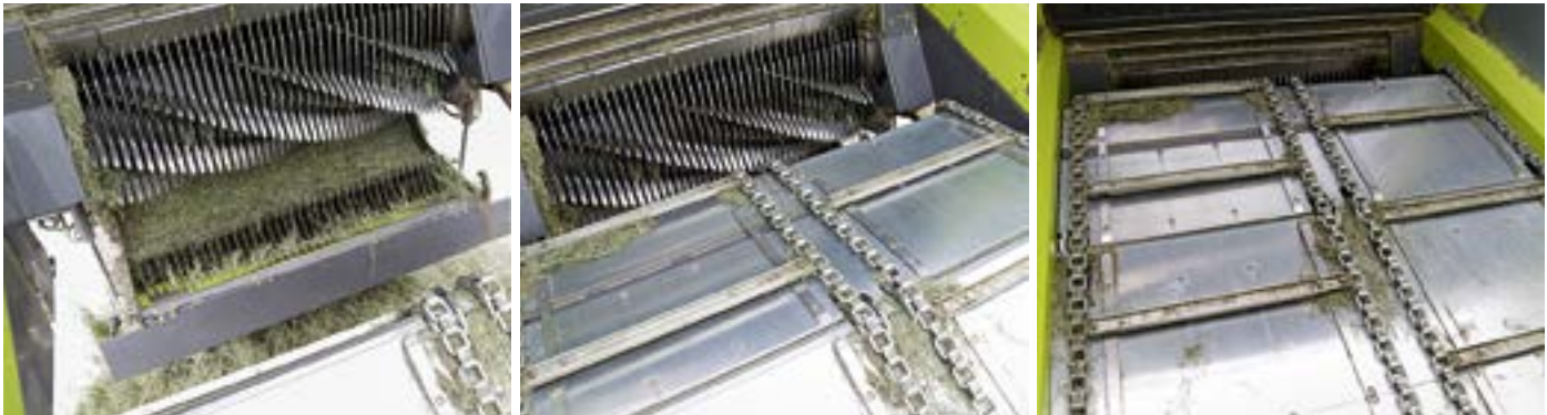
Der vordere Kratzbodenteil wird hydraulisch nach unten geschwenkt. Für den Einsatz als Ladewagen bleibt der Kratzboden um 500 mm nach vorn abgesenkt. Für die Restentleerung kann der Kratzboden hydraulisch waagrecht geschwenkt werden.
